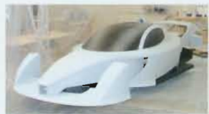
モックアップはFRPで造られたが、実車はカーボンクレーでボディパネルを製作予定だという。
