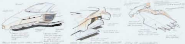
スケッチ各種。F1マシンをモチーフに、さまざまなアイデアが盛り込まれたことがわかる。フラットボトムやディフューザーなど現在の最先端といえる空力的アイデアも十分マシンに反映されている。
