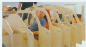
1分の1のモックアップの作製風景。キャビンは大人ふたりが十分に乗れるスペースを確保している。
